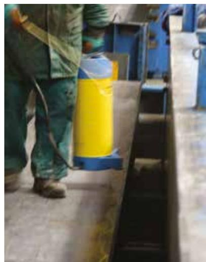
AGENTS DE DÉCOFFRAGE CHIMIQUES POUR BÉTON PRÊT À L'EMPLOI ET PRÉFABRICATION
