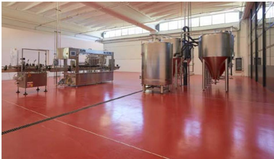
Il rivestimento della pavimentazione interna dell'area produttiva è stato realizzato impiegando il sistema resinoso a spessore DRACOFLOOR MD, chimicamente resistente,
